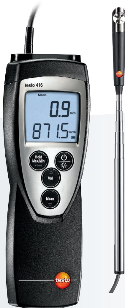
testo 416은 베인 프로브가 장착된 소형 풍속계입니다. 지름이 16 mm인 베인을 최대 890 mm까지 늘일 수 있어 덕트 안의 풍속을 측정하는 데 최적입니다. 손쉬운 덕트 사이즈 입력을 통해 풍량을 측정하여 디스플레이 할 수 있습니다. 또한 풍속, 풍량 및 풍온 평균값(시간, 횟수) 측정기능으로 평균 풍량에 대한 정보를 제공합니다.
