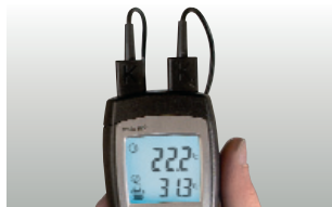
두 개의 프로브를 연결하여 온도 기록과 측정 온도차이 표시
