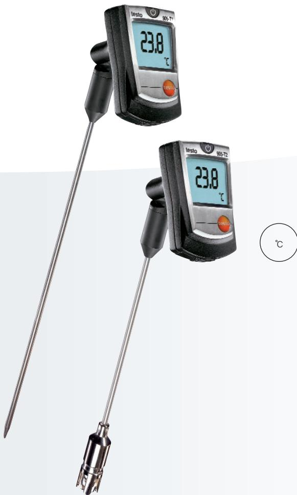
testo 905-T1은 -50 ~ +350 °C 측정범위의 빠른 침투형 온도계로 단시간에 500 °C(1~2분)까지 측정가능 합니다. 이 제품은 전문 산업용 센서(열전대 K타입)로 우수한 정확도와 측정범위를 가지고 있습니다.
