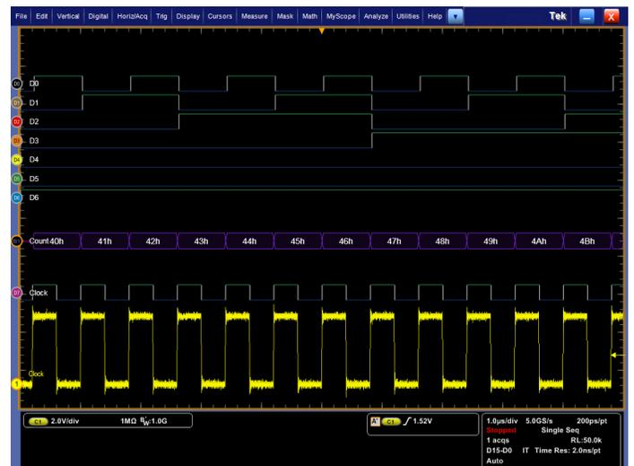
컬러 코딩 된 디지털 파형 디스플레이를 사용하면 낮은 값은 파란색으로 표시되고 높은 값은 녹색으로 표시되어 전환의 표시 여부에 관계없이 버스 값을 즉시 이해할 수 있습니다.
