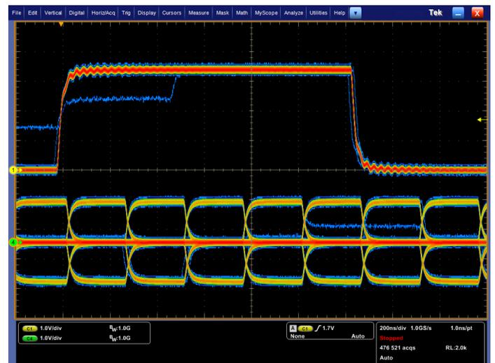
디스커버리 - 빠른 파형 캡처 속도 - 250,000 wfms/s 이상 - 까다로운 글리치 및 기타 드문 이벤트 캡처 가능성을 최대화 합니다.
