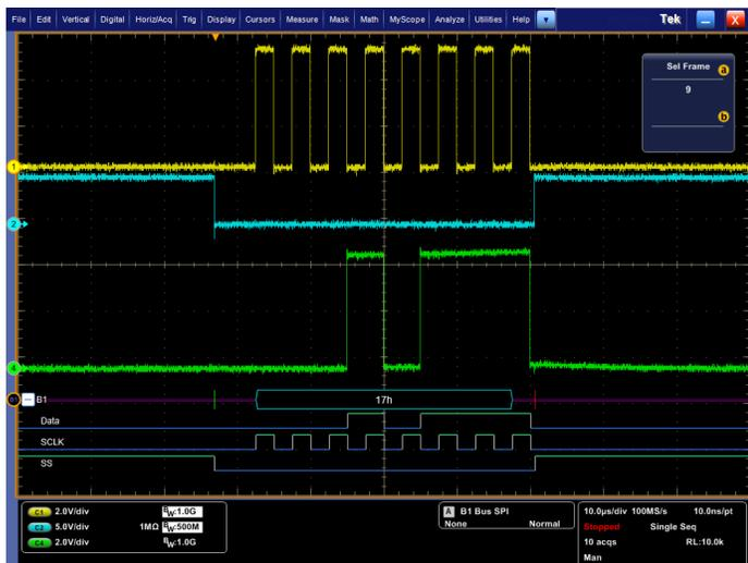
**FastFrame™** - 사용자가 선택할 수 있는 메모리 세그먼트를 통해 SPI 버스 데이터의 타임 스탬프 캡처와 여러 데이터 패킷의 직렬 버스 디코딩 분석을 통해 효율적인 메모리 관리가 가능합니다. 프레임 1, 2 및 9가 여기에 표시됩니다.
