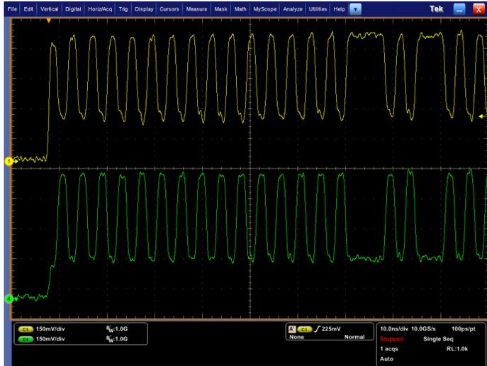
성능 - 최대 2 GHz 대역폭 및 10 GS/s 샘플링 속도로 진정한 충실도와 100 ps 해상도의 USB2.0 480 Mb/s 차동 신호를 캡처 합니다.
