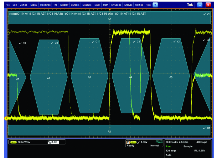
부울린(Boolean) 로직 트리거 자격입니다. 로직 OR을 사용한 부울린(Boolean) 로직을 통해 사용자는 각 비트를 동시에 모니터링하고 획득의 모든 포인트에서 발생한 이상을 캡처할 수 있습니다.
