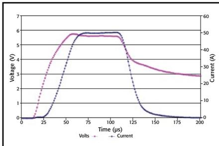
듀얼 디지털링 A/D 컨버터는 최대 1µs/point로 샘플링 하여 전류 및 전압 파형의 완전한 동시 특성 분석이 가능합니다.
