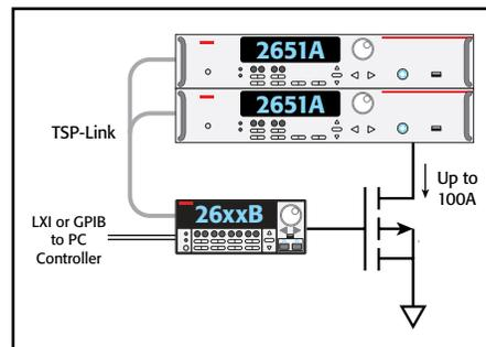
Keithley의 TsP 및 TSP-Link Technologies는 메인 프레임 기반 시스템의 전력 및 / 또는 채널 제한 없이 진정한 핀당 SMU 핀 테스트를 지원합니다.
