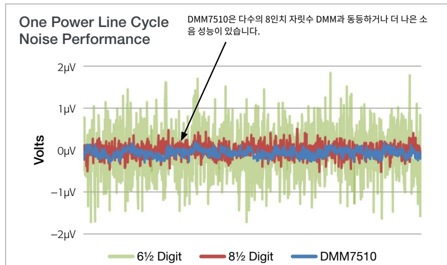
DMM7510의 1VDC 노이즈 성능과 일반적인 6μm 및 8μm의 노이즈 성능을 비교합니다. 모든 데이터는 입력에 낮은 열 단락을 적용하여 1 NPLC에서 수집되었습니다.
