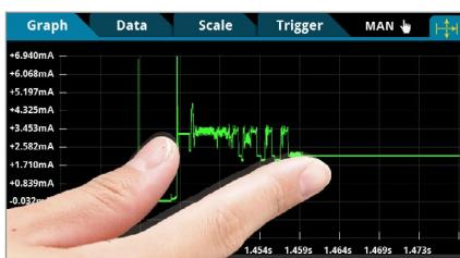
DMM7510의 디지털화 기능이 있는 구성 요소 또는 제품의 모든 작동 상태(절전 모드에서 활성 전송 모드로)에서 전류 방전을 캡처 하십시오. 터치스크린 편지 및 확대/축소 기능을 사용하여 파형의 특성에 집중하십시오.
