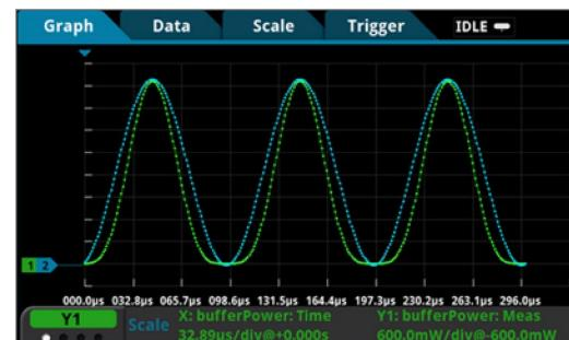
내장 그래픽 유ти리티는 최대 4개의 판독 버퍼에서 측정 또는 파형을 한 번에 표시 및 비교하는 기능을 지원합니다.
