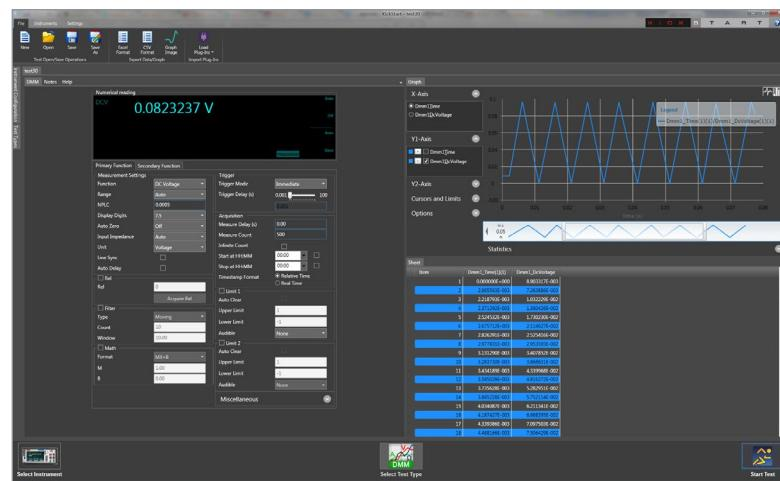
Keithley의 KickStart 기기 제어 시작 소프트웨어를 사용하면 몇 분 안에 측정을 시작할 수 있<sup>m</sup>에도.
