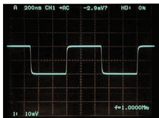
入力: 1 MHz 矩形波 200 mAp-p (オシロスコープの帯域400 MHz)
